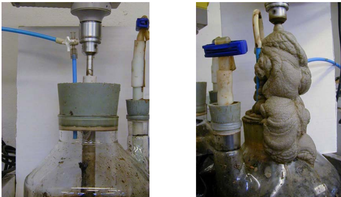
Figur 23. Två försöksreaktorer från laboratoriet på Tekniska Verken i Linköping för utveckling av processhjälpmedlet KMB1. Det vänstra fotot visar försöksreaktorn med KMB1 tillsatt och det högra fotot visar referensreaktorn. Fotona är tagna samma dag, under tiden försöket pågick med hög belastning.
